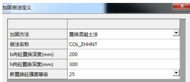
图 2.10 置换混凝土法定义
